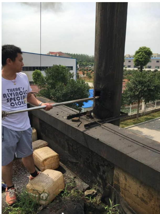
4 吨燃煤锅炉烟囱采样
