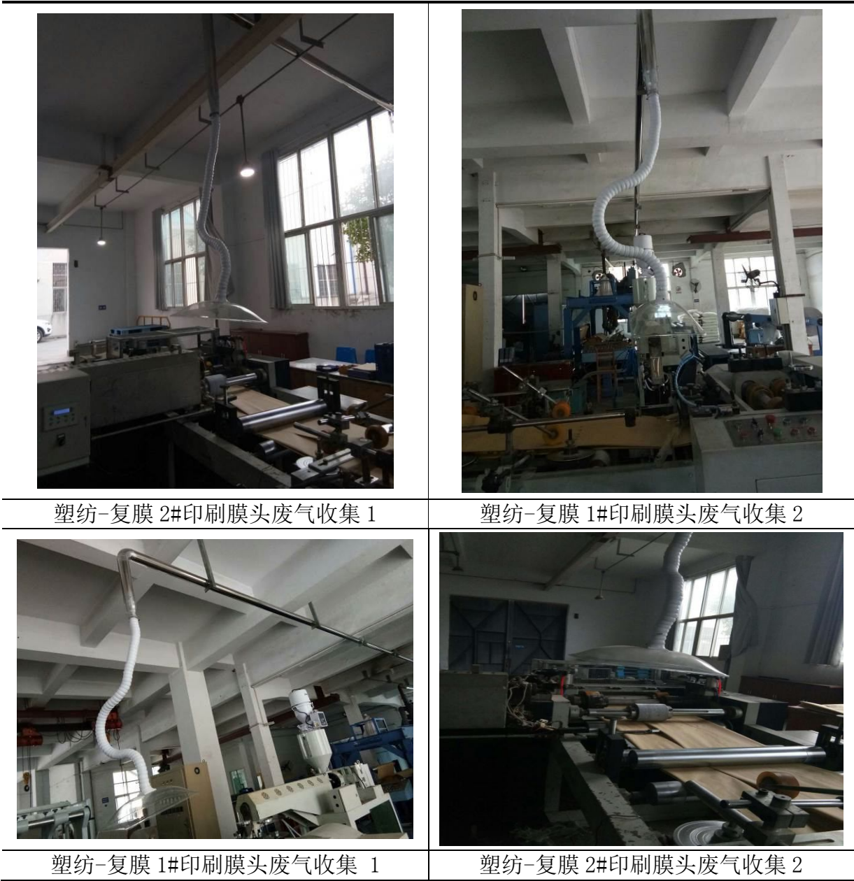
图 3-13 废气处理设施（收集）示意图
