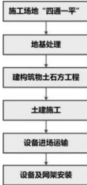
图 1 变电站工程施工工艺流程
