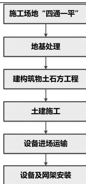
图 1 变电站工程施工工艺流程
