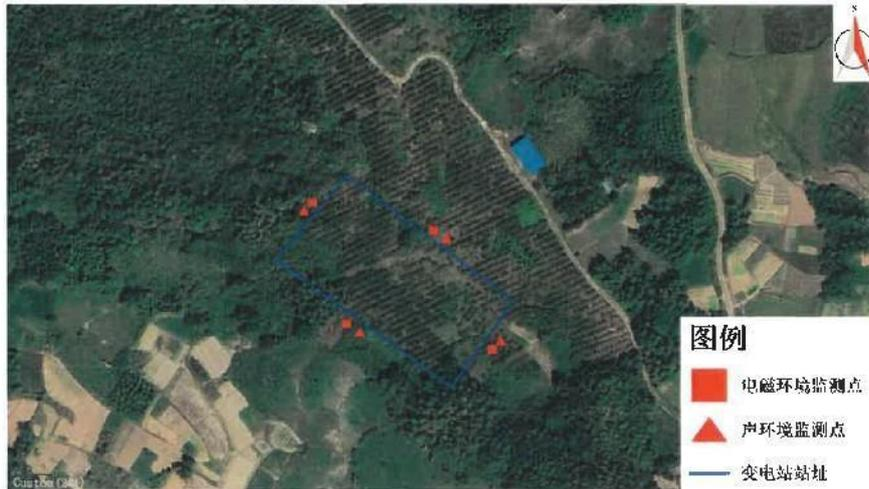
附图1 湖南省岳阳市临湘市临湘东 220kV 变电站电磁环境、声环境测试布点示意图
