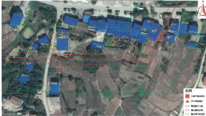
附图 13 长安街道路口铺村老屋组 1 电磁环境、声环境测试布点示意图
