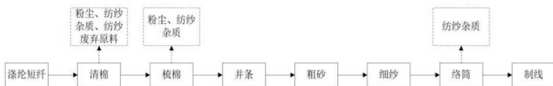
图 2-4 现有项目纺纱产品生产工艺流程图
