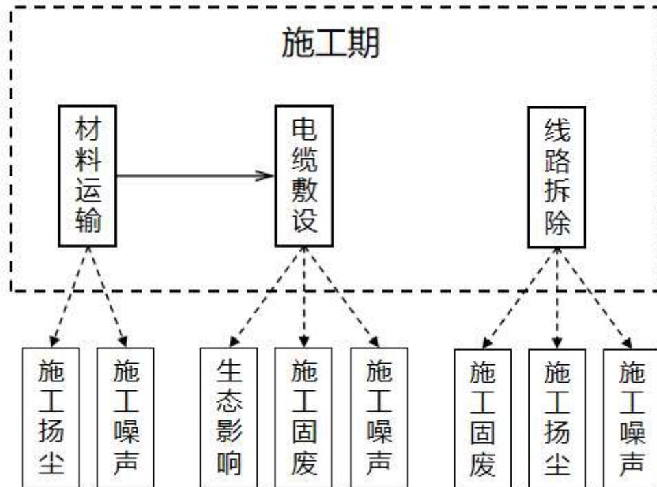
图 3 本工程电缆施工期的产污节点图
