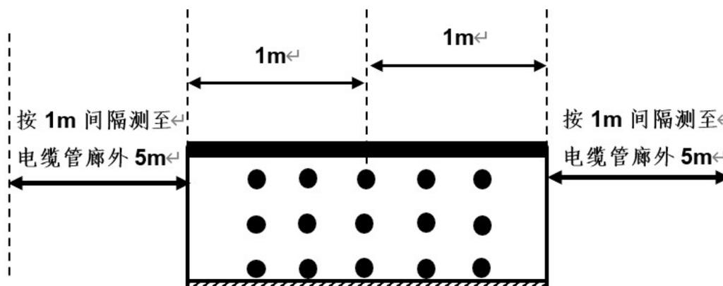
图 5 110kV 秀枫延线、110kV 秀枫长延线、110kV 秀陶岳线、110kV 秀梅线电磁衰减断面监测示意图
