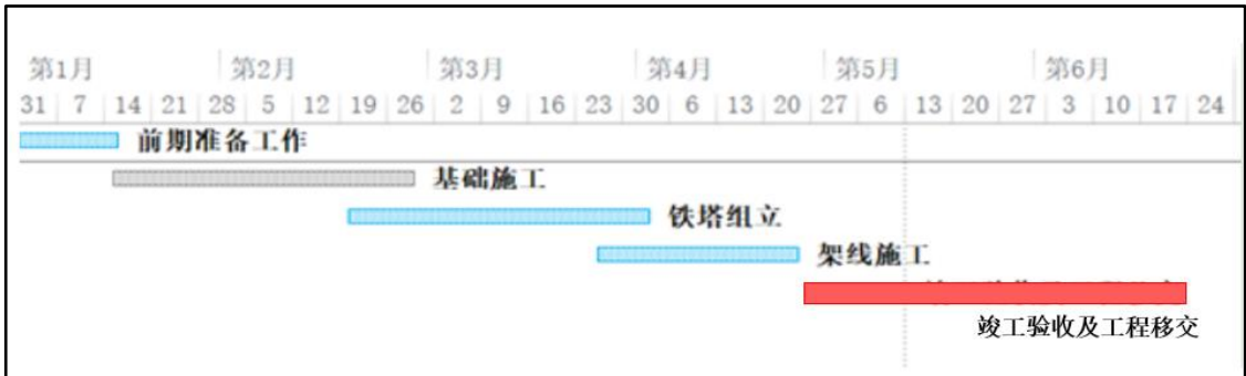
图 7 新建输电线路施工时序图
