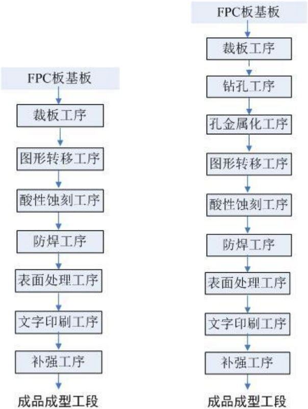
图 2.2-23 FPC 单（左）/双（右）面板生产工艺流程总图
