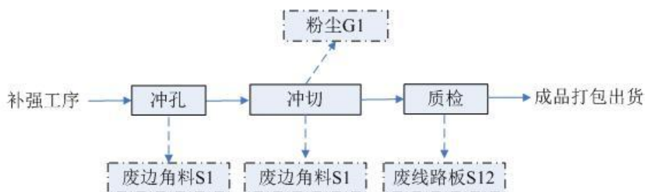
图 2.2-32 成品成型工段工艺流程及产污节点图
