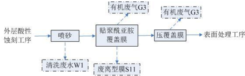
图 2.2-29 软板防焊工序工艺流程及产污节点图
