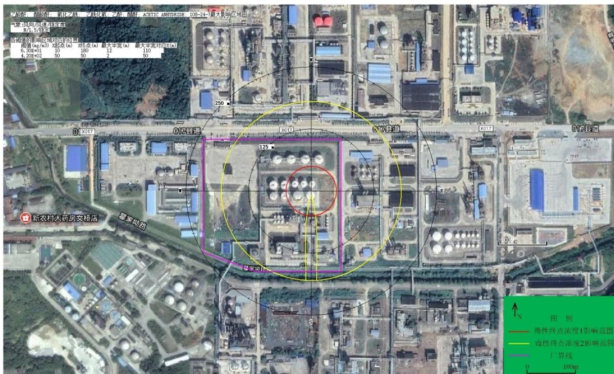
图 7.6-2 乙酸泄漏在预测时间内影响范围图
