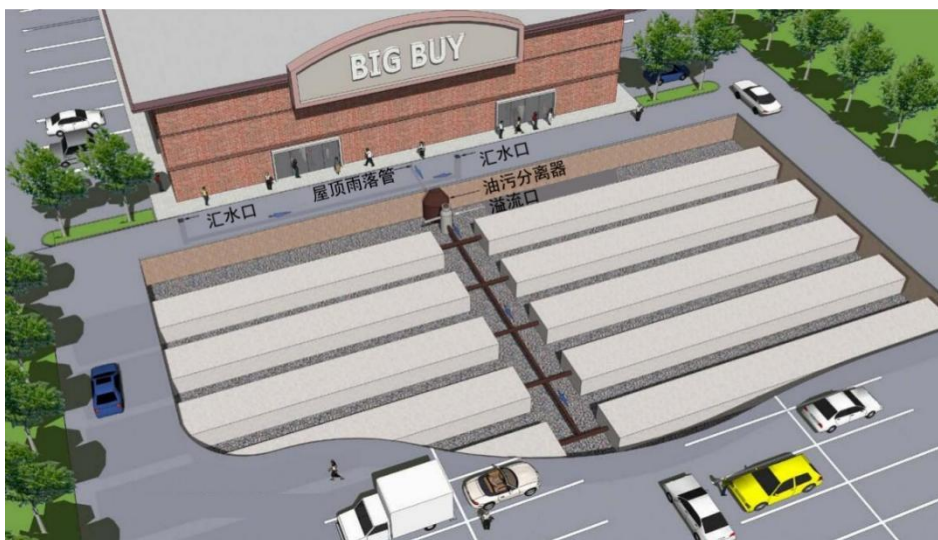
图 9-22 典型渗渠、渗室布置平面和剖面图
