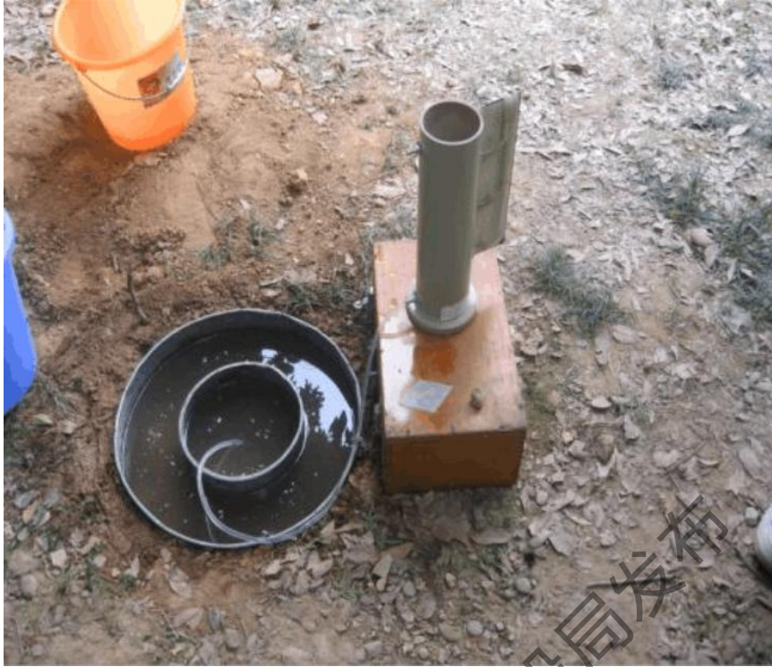
图 10-6 双环法渗水试验示意图
