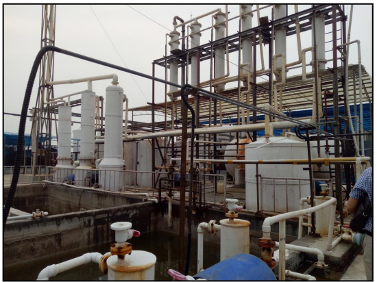
废气处理系统（碱液吸收+水吸收）
