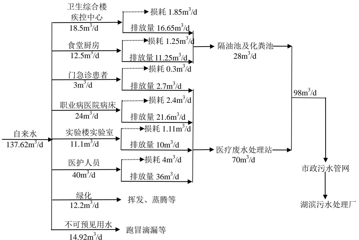
图 5.2-4 项目总水平衡图
