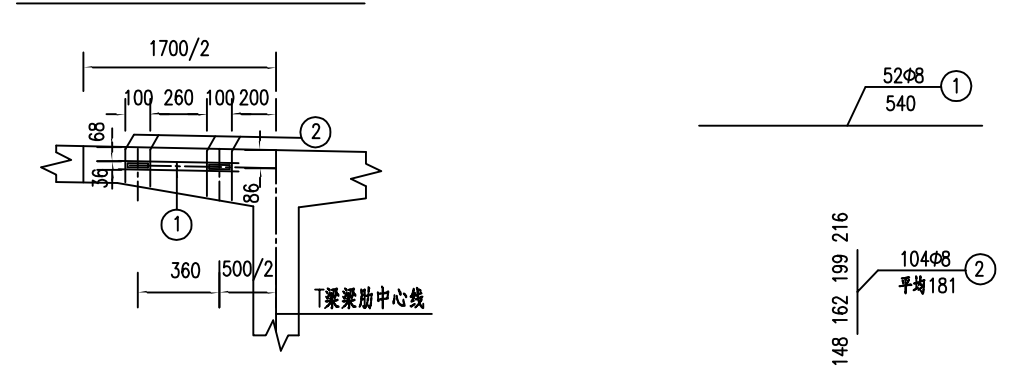
连续段钢束定位网侧面布置
