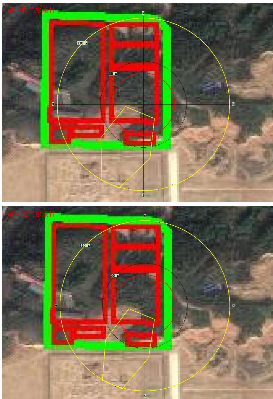
图 9.5.1-7 芳烃油储罐破裂泄漏丙苯蒸发扩散最大影响范围一览表
