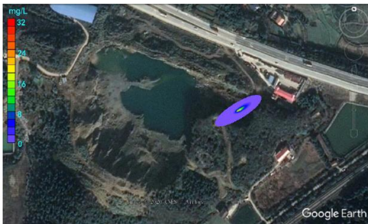
图4.5-12 图 4-4 设定情景 5 年后 As 污染预测
