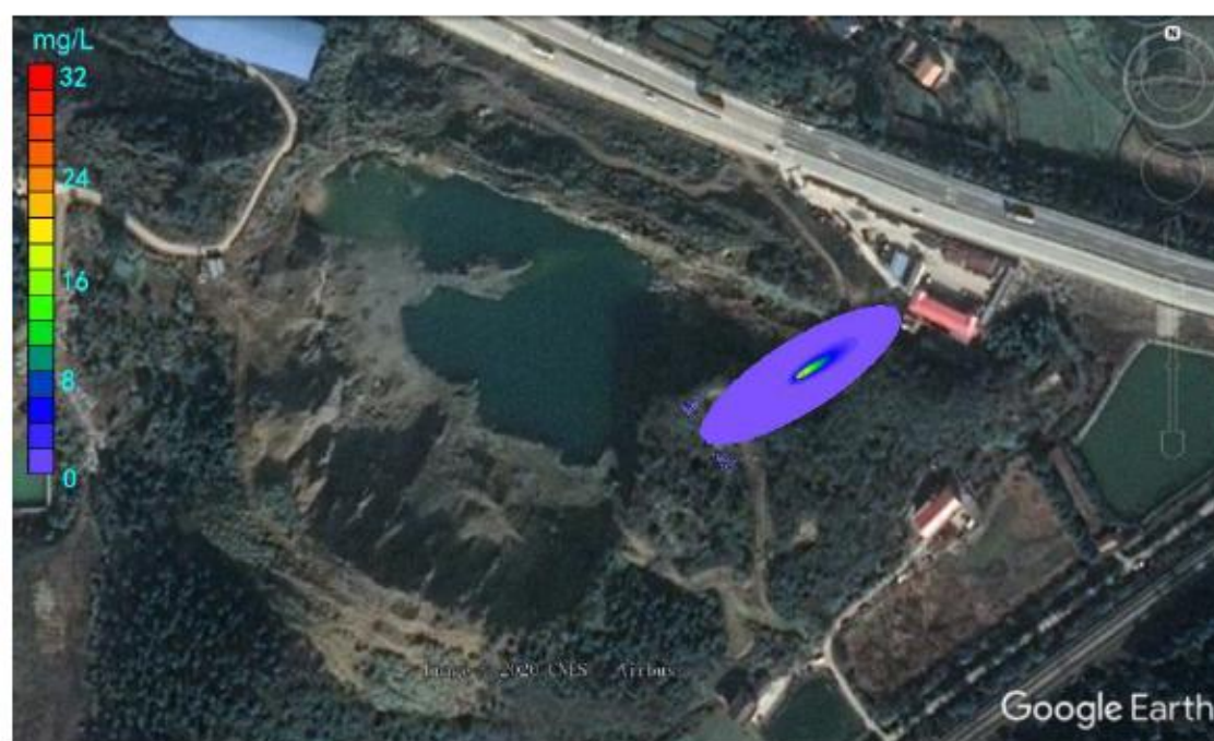
图4.5-9 设定情景 10 年后氟化物污染预测
