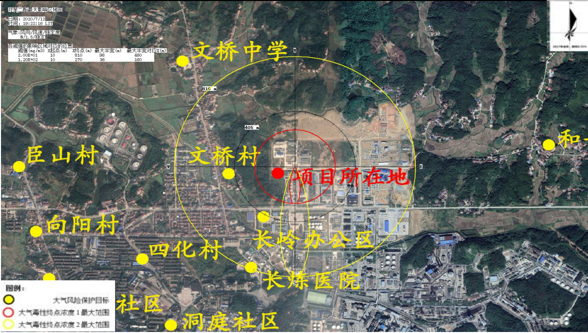
图 5.6-3 对苯二酚发生火灾燃烧事故后最不利气象条件下毒性终点浓度的最大影响范围图
