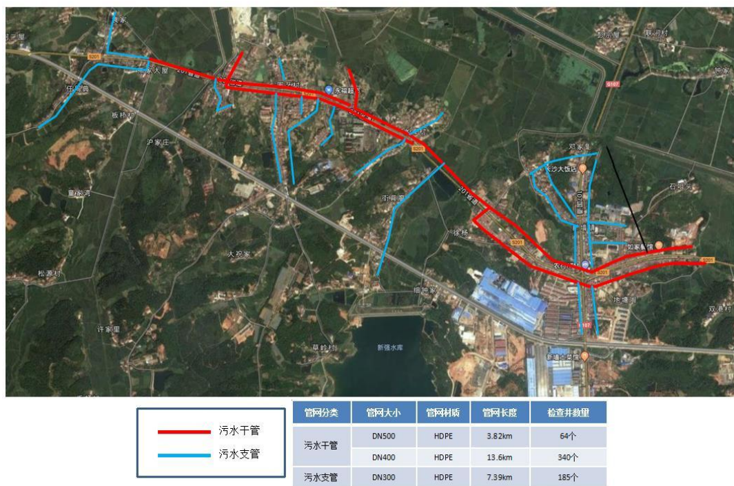
图 1-1 本项目污水管网布置图
