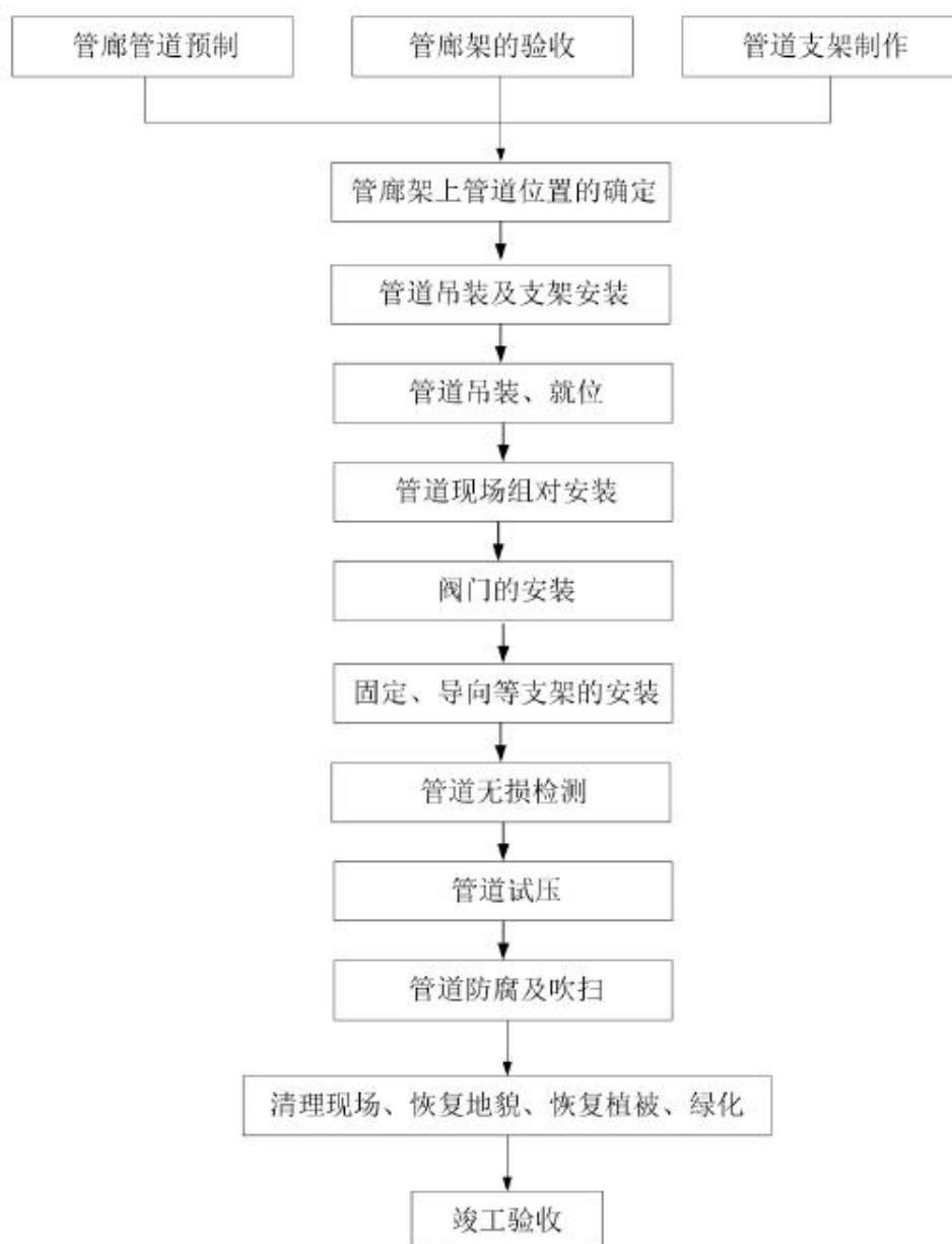
图3.2-2 本项目管廊施工工艺图
