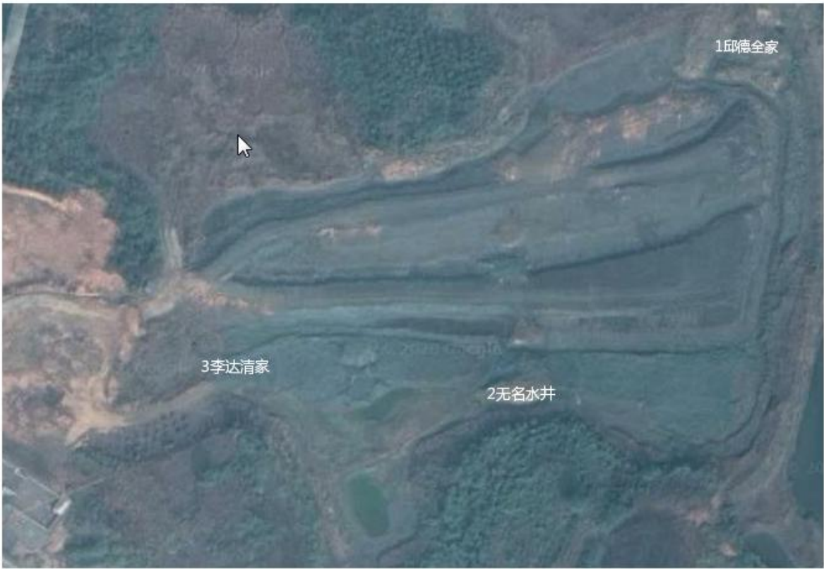
图 4.2-1 地下水检测布点图
