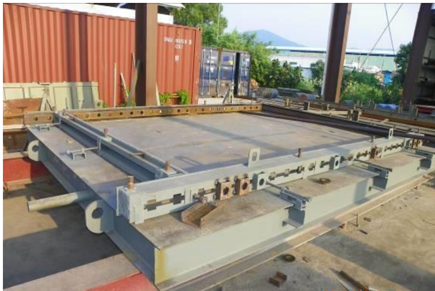
预制构件模具底板边模拼装
