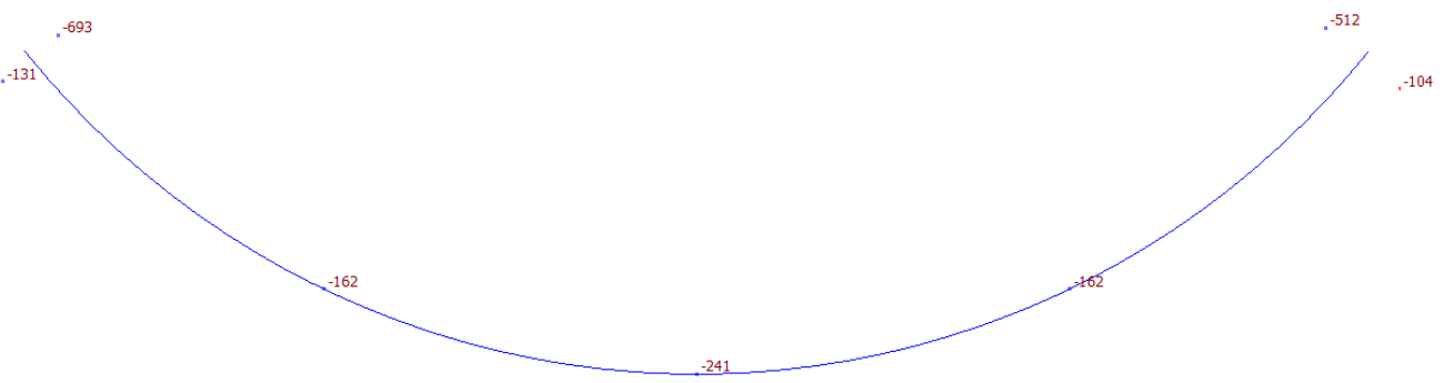
图 4.3.3-3 城-A 级偏载作用下支座最小反力
