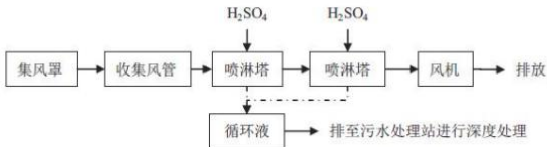
图 1.5-3 碱性废气处理工艺流程图
