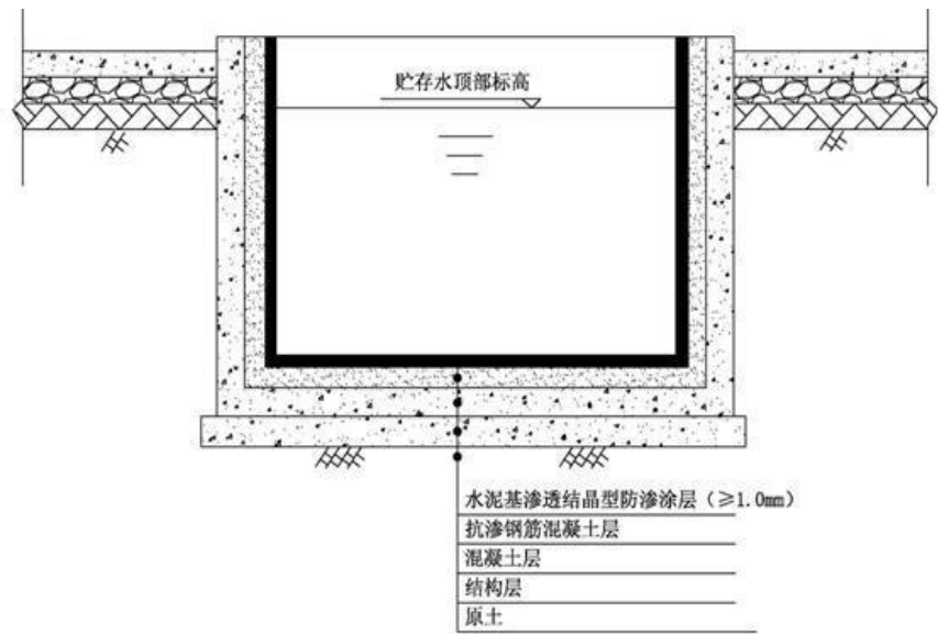
图8.2-5 水池防渗结构示意图
