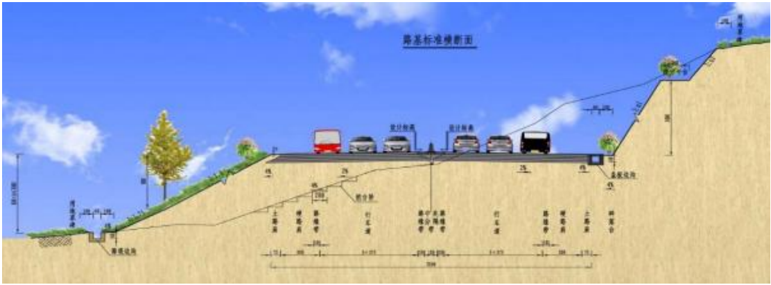
图3.2-7 32m路基宽度绿化标准横断面图
