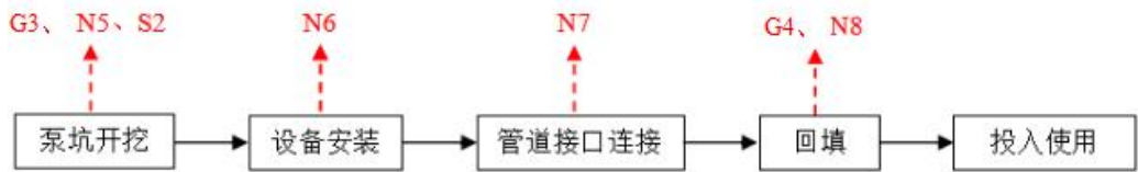
图 2-1 本项目新建雨污管道施工工艺流程及产排污环节图
