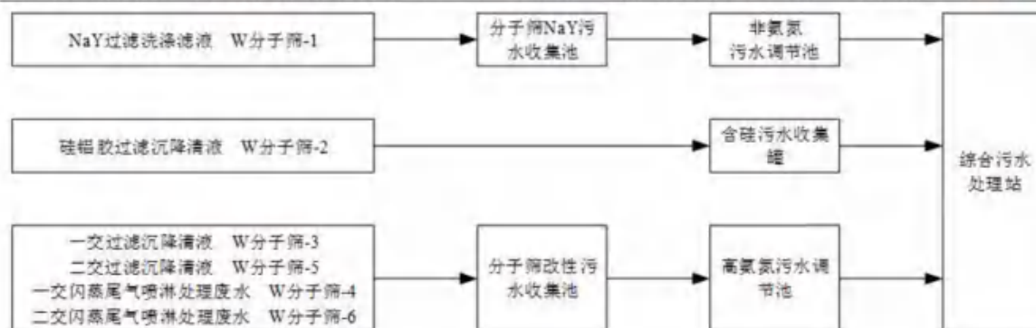
图 2.1-3 NaY 分子筛装置废水收集示意图
