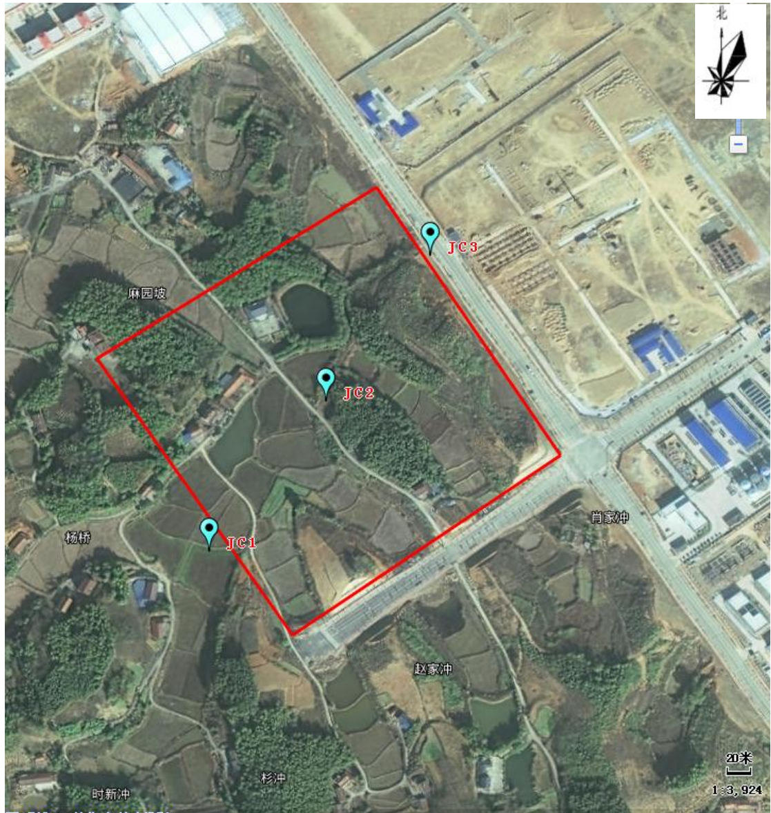
图 7.2.3-6 地下水环境监测点布置示意图
