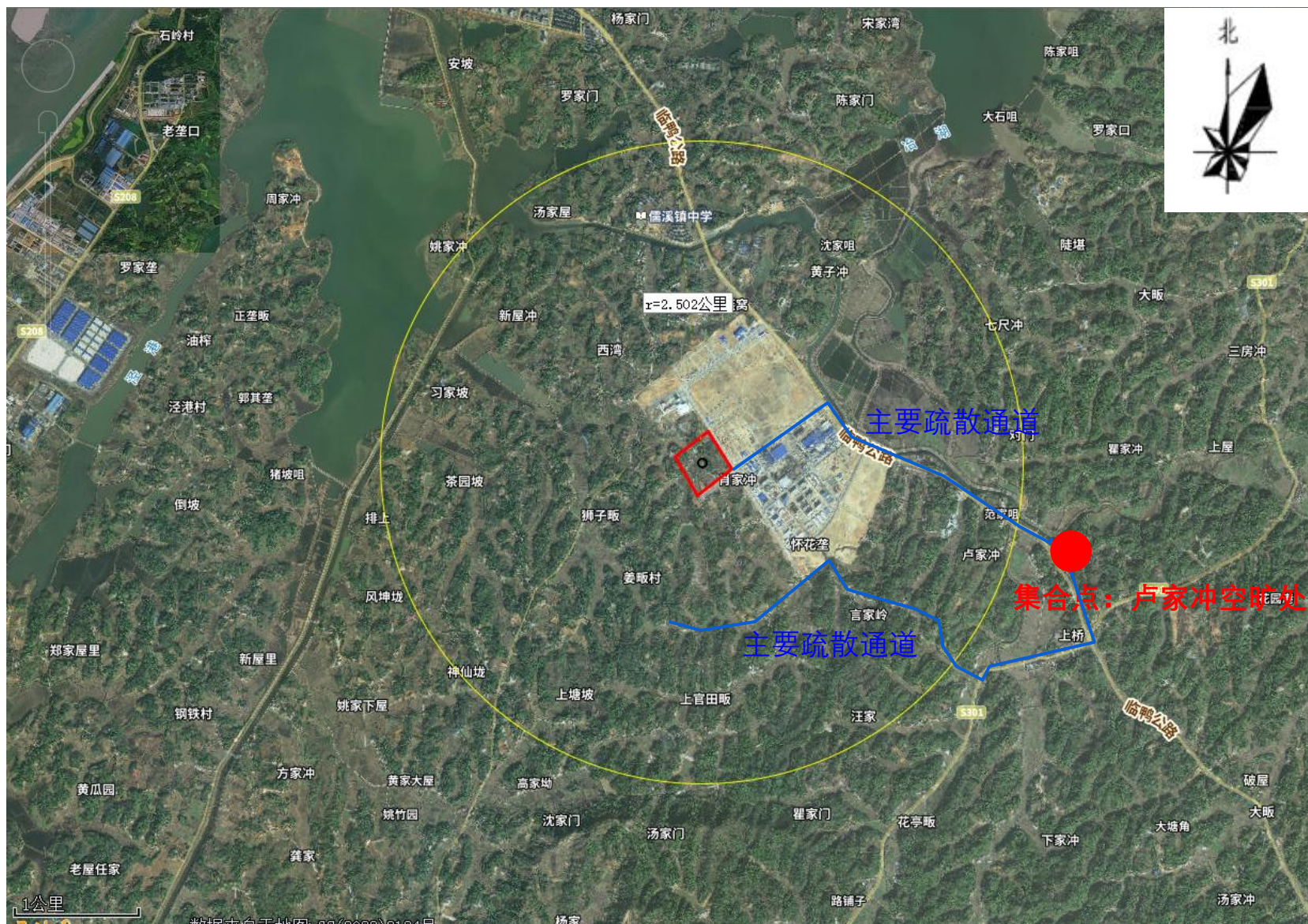
图 7.3.7-1b 本项目应急疏散图（场外，发生事故时风向为主导风向）
