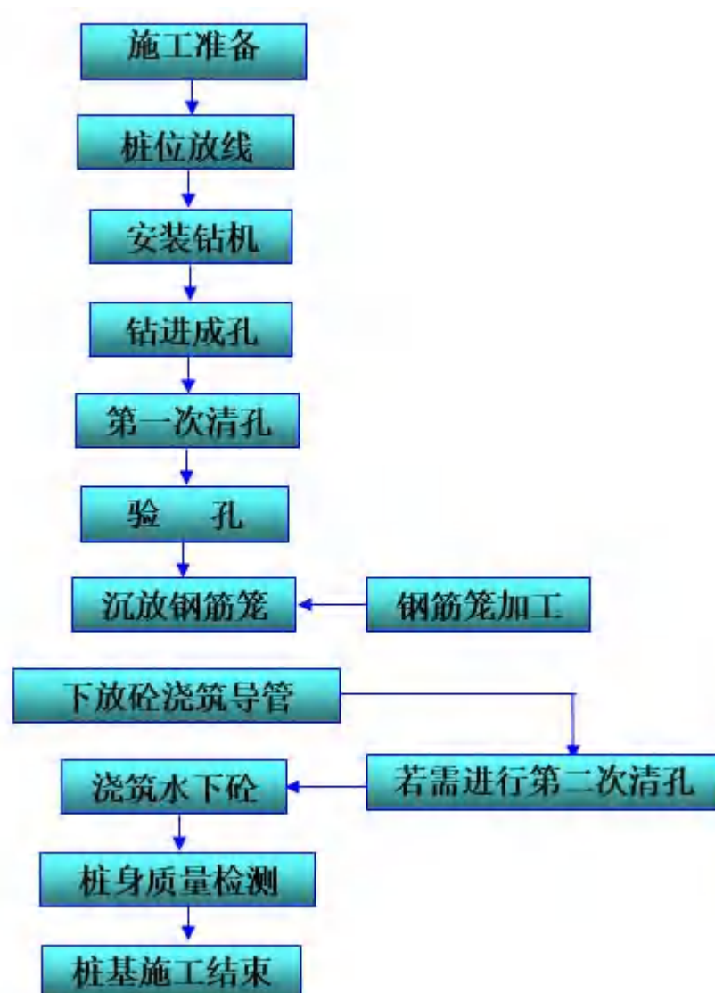
图 2-6 钻孔灌注桩施工工艺流程图
