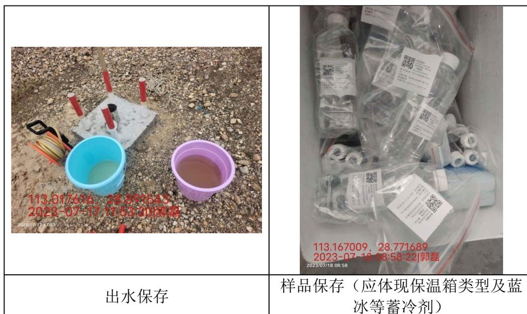
图 5-5 地下水洗井与采样照片
