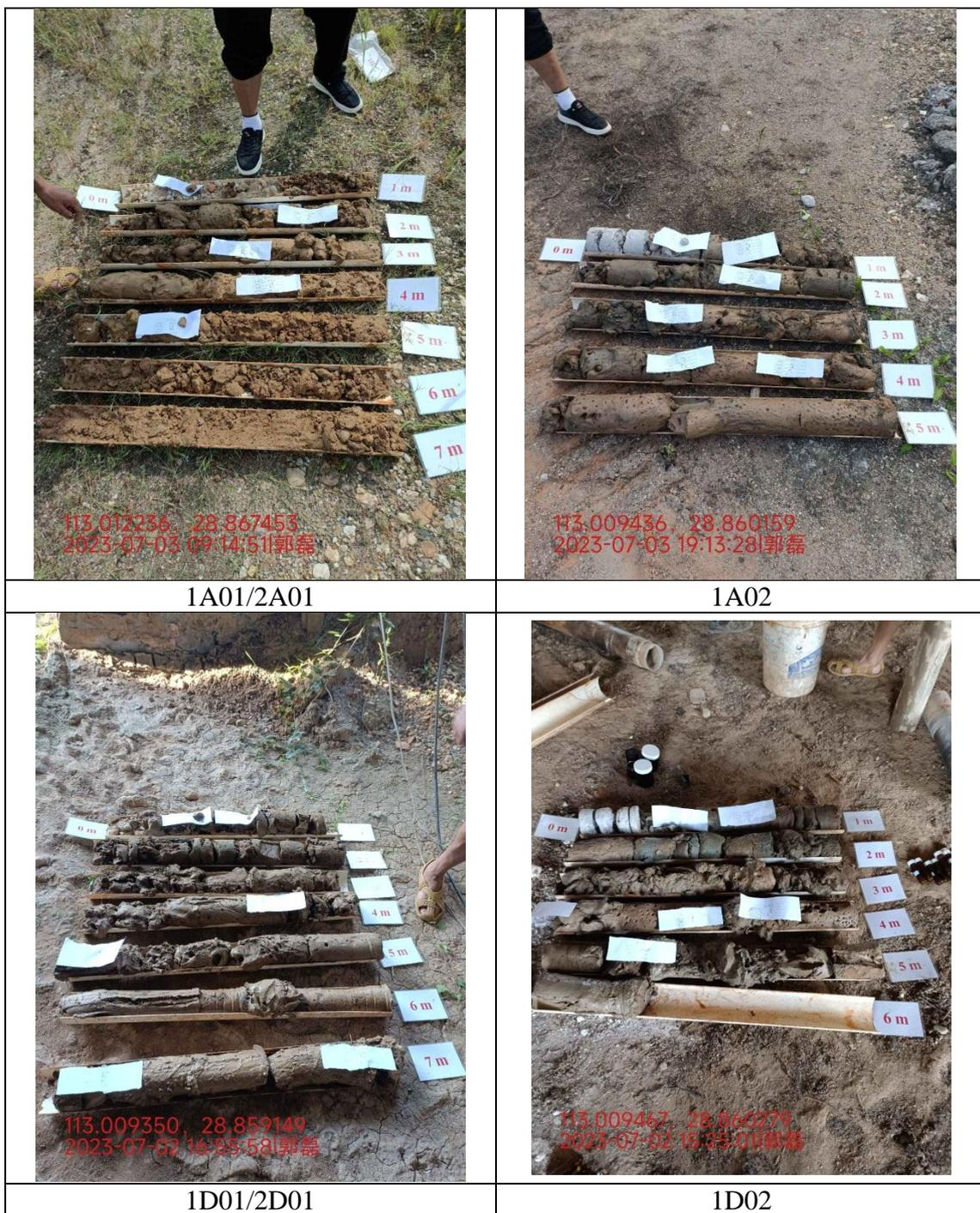
图 5-2 钻孔岩芯照片
