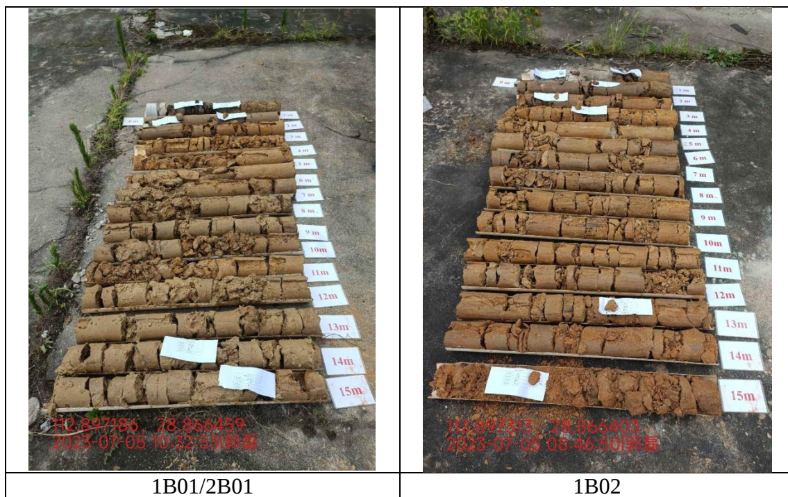
图 5-2 钻孔岩芯照片
