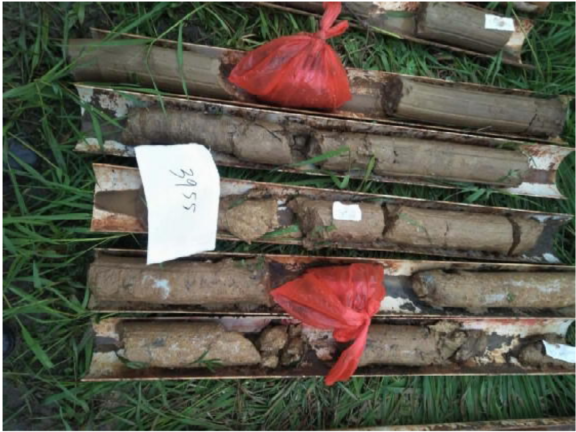
QZK3 钻孔岩芯照片（粉质黏土）
