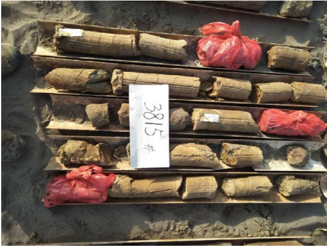
QZK2 钻孔岩芯照片（粉质黏土）
