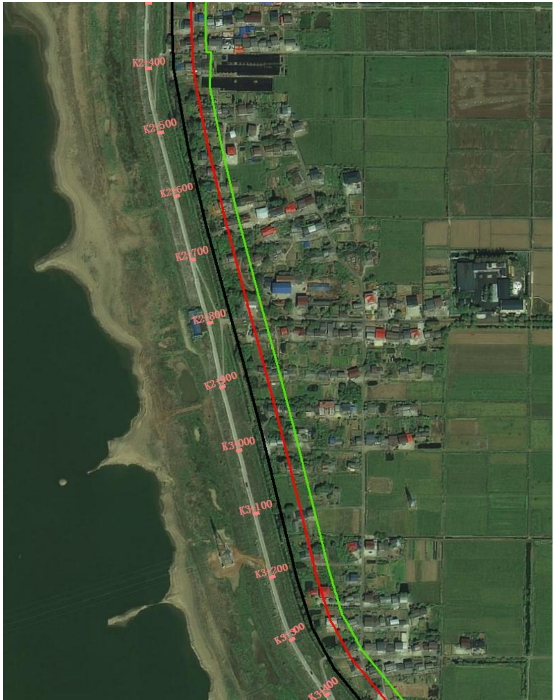
图12 湘江东支右岸有堤防段划界示意图
